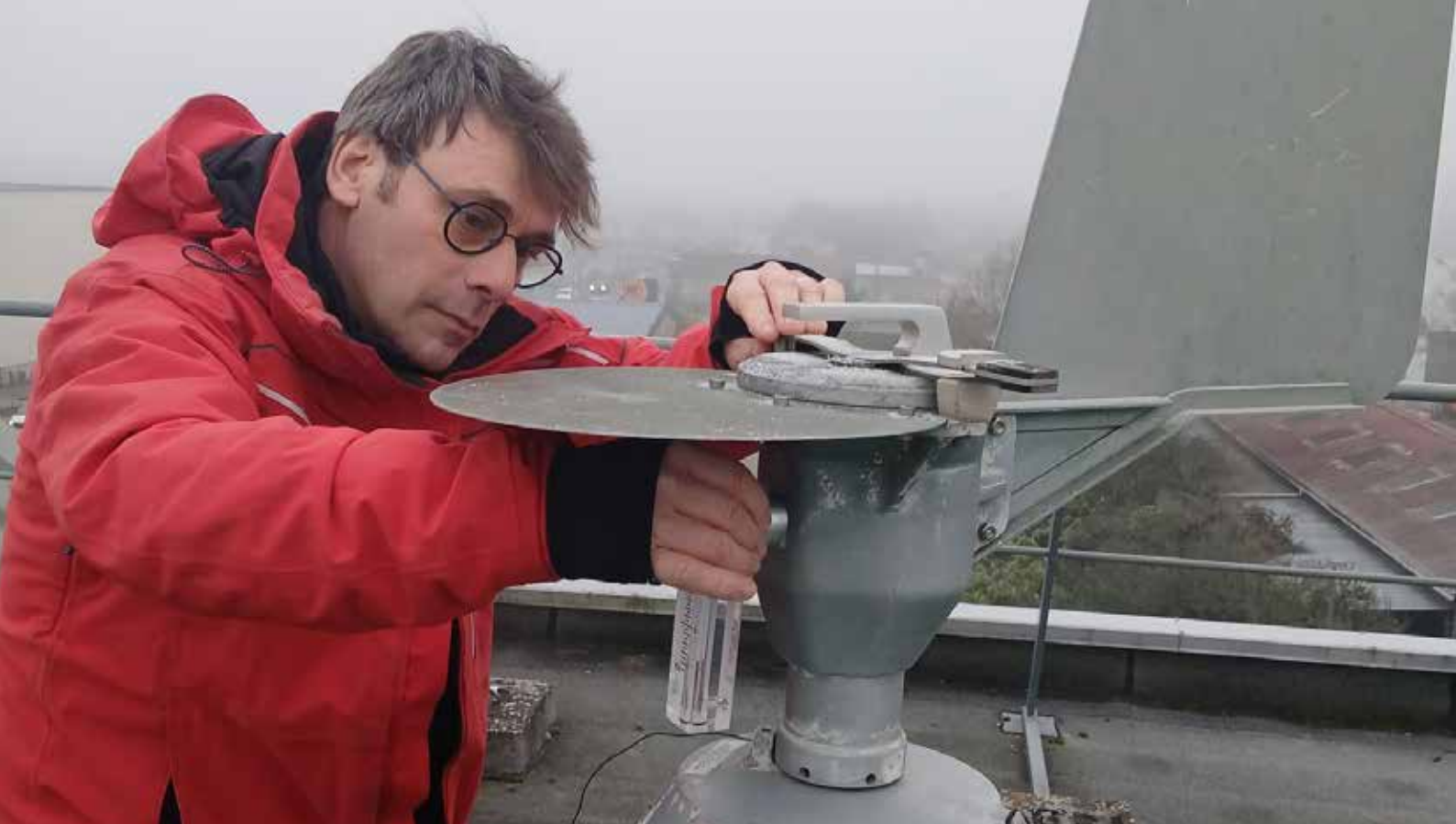
Mise en place et contrôle du dispositif de prélèvement de pollens sur le capteur de Chalon-sur-Saône
